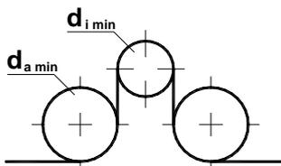
Minstdurchmesser einer zylindrischen Innenrolle:  $d_{i \min} = 60 \text{ mm}$
